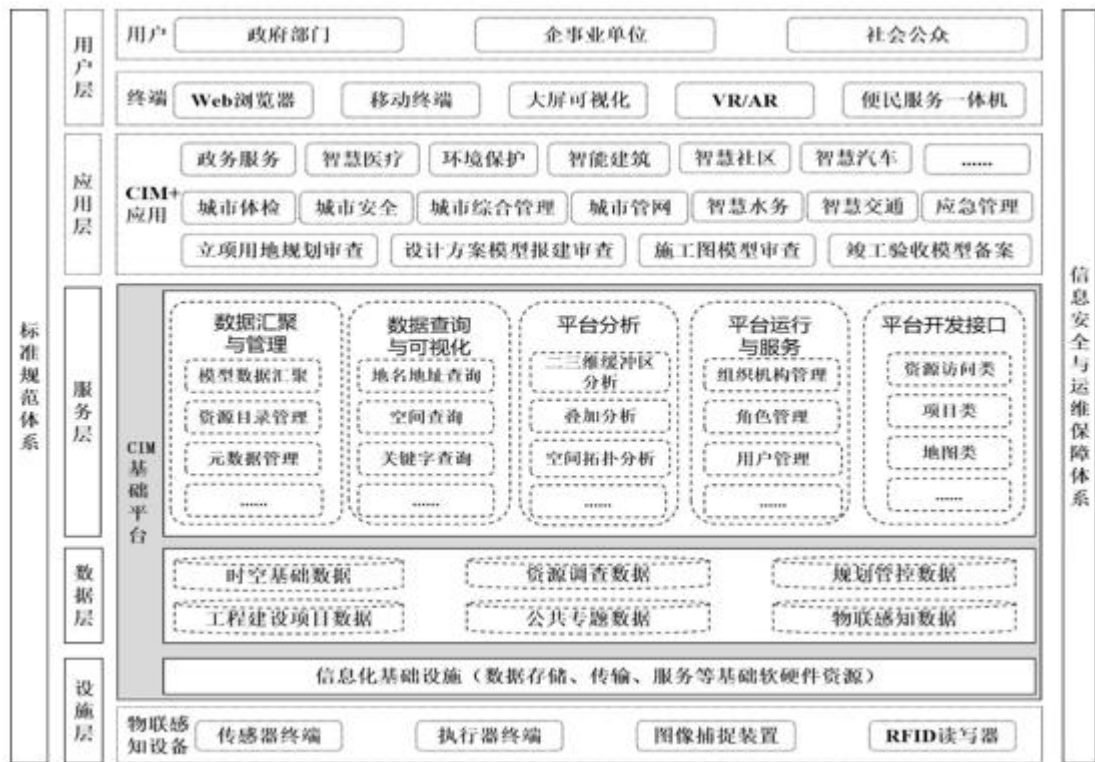
图 3.3.1 CIM 基础平台总体架构及其支撑作用
