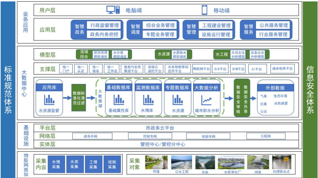
图 1 智慧水务总体技术架构范例
